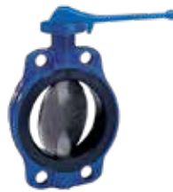
Série 75/31 Vanne papillon concentrique à manchette fixe Demi oreilles taraudées Fonte ductile DN 50-300 Tout type d'actionneur
