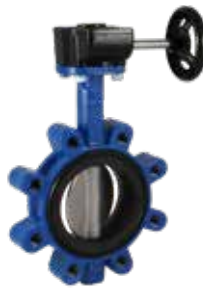
Série 820/10 Vanne papillon concentrique à manchette libre Oreilles taraudées Fonte ductile DN 25-600 Avec tout type d'actionneur
